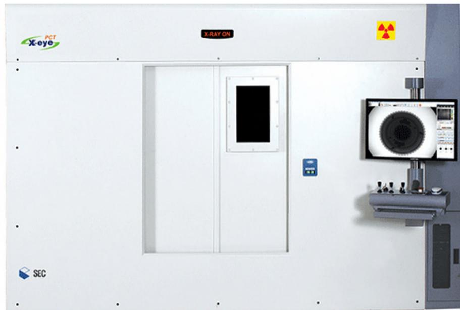
**Система компьютерной томографии 7000В** применяется для контроля компонентов среднего и крупного размера. Томограф 7000В позволяет обнаруживать структуру поверхности и дефекты (внутренние пустоты и трещины и т.д.).
